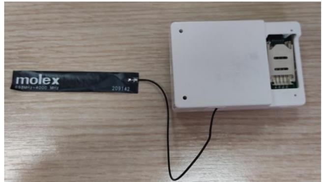
La tarjeta RP432G400LAA contiene un módulo de radiofrecuencia de la marca TELIT y modelo LE910C1-LA con código FCC ID R17LE910CXLA.
