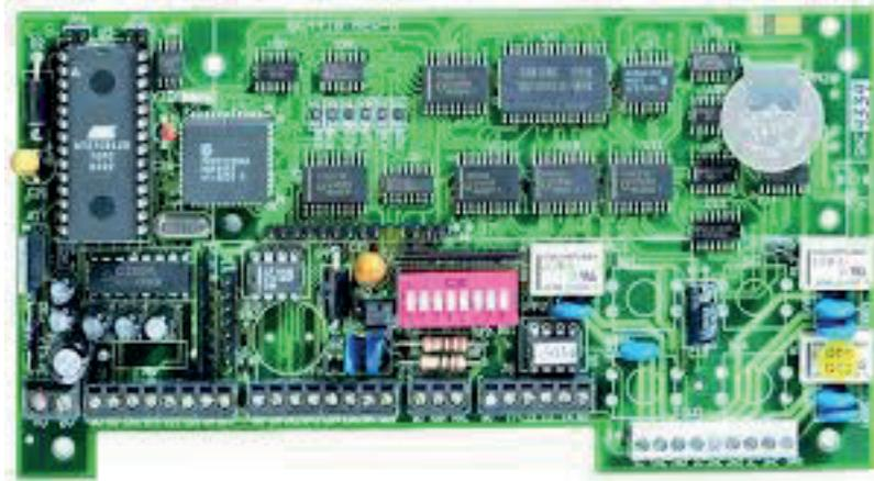
Módulo de control de acceso para administrar 2 lectores, conexión de autobús. Gestión de 2 lectores para el control de dos puertas o una puerta con antipassback función. Memoria 1000 transacciones residente en el módulo. Relé de desbloqueo de puerta del relé de alarma. Posibilidad de conectar hasta un máximo de 8 módulos para el control de 16 puertos (ProSYS 128)
