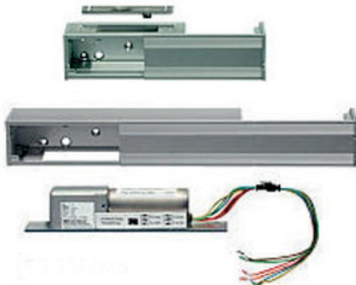
El SD-997SMB-AQ es un kit de soporte para montar la cerradura eléctrica, permite su montaje sin utilizar los marcos de las puertas para esas situaciones donde montar la cerradura dentro del marco no es posible por un espacio muy estrecho o en consideración al tipo de material utilizado en las puertas.
